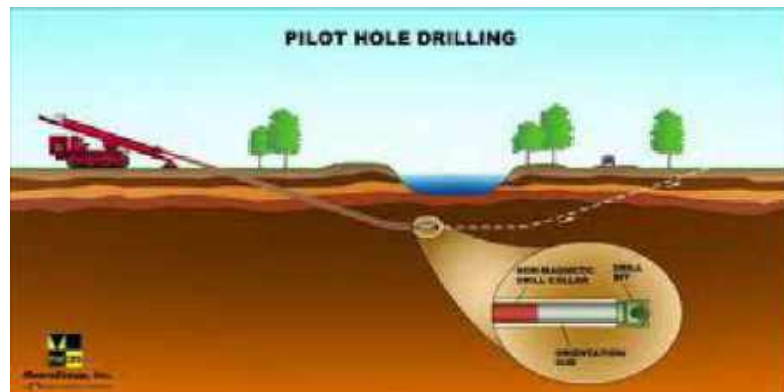
Gambar 2.45 Ilustrasi Pengeboran Pilot Hole
