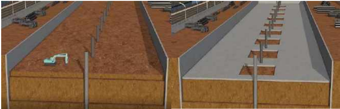
Gambar 2.22 Ilustrasi Penggalian Pertama dan Pengecoran Roof Slab
