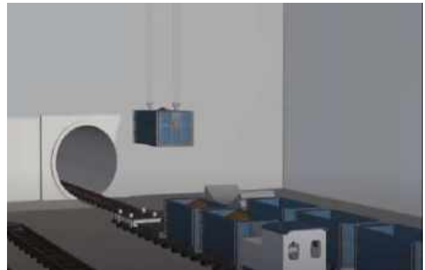
Pengangkutan tanah hasil galian menggunakan lokomotif, kemudian diangkat menuju cut and cover area di atas permukaan tanah
